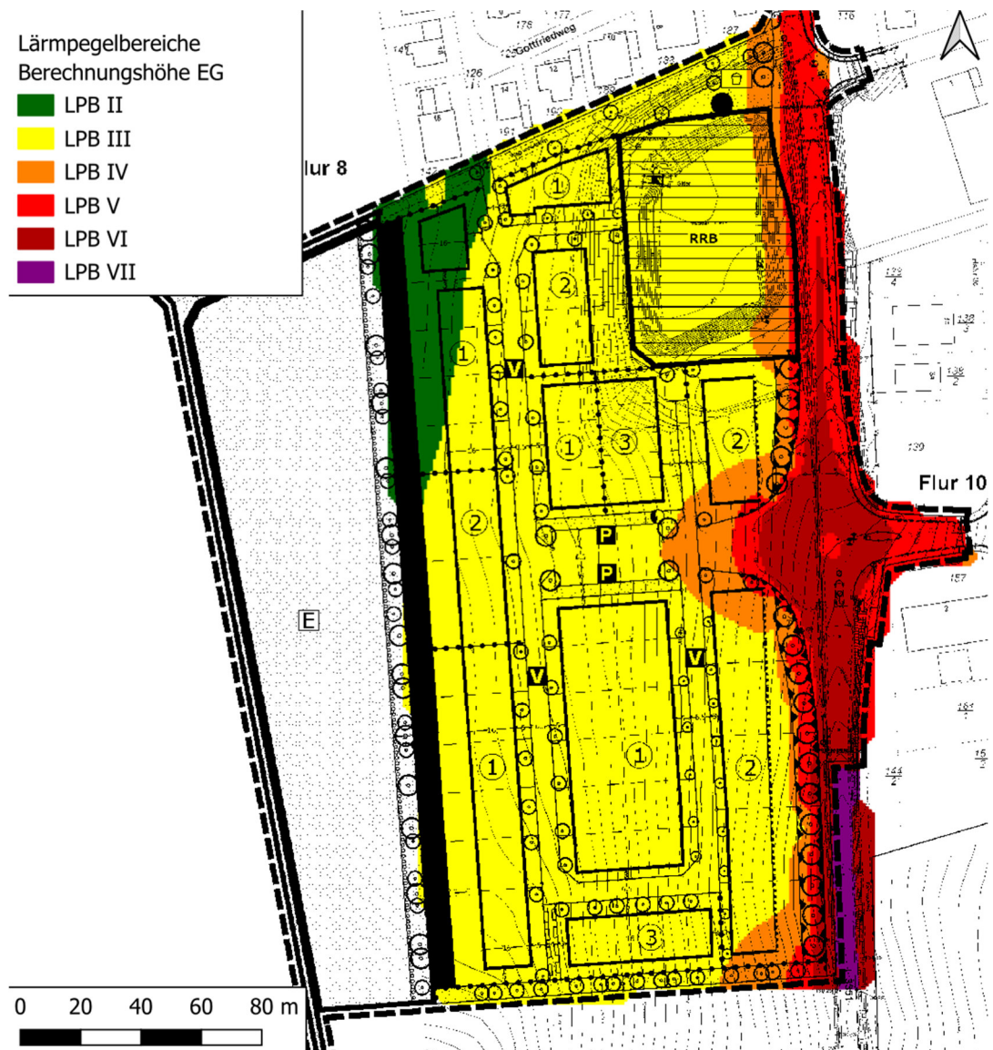
Abbildung 1: Lärmpegelbereiche nachts gemäß DIN 4109-1/-2:2018-01, Immissionshöhe EG unter Berücksichtigung eines Lärmschutzwalls
